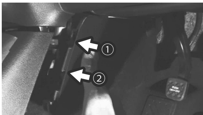
①フックを金属フレームに掛ける → ②プッシュロックを差込む
