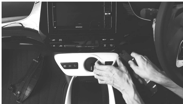
指で手前に引っ張ってすき間を作り、リムーバーを差込む。
